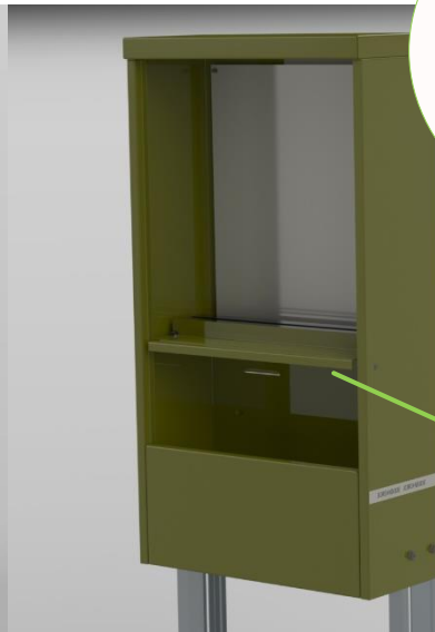
Øverste låge er her afmonteret. Bemærk skydeflange / fugtspærren. Der er 200mm ventileret rum over jordhøjde. Ventilering med gæller sikrer et tørt rum og dermed minimering af potentiel fugt op i skabet.
